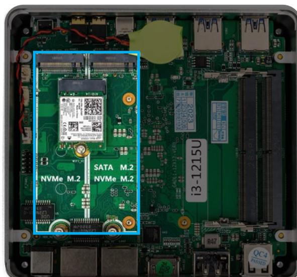
2) Вставьте разъем нового твердотельного накопителя в гнездо на системной плате под углом примерно 30° (1) и закрепите его с помощью винта (2).
