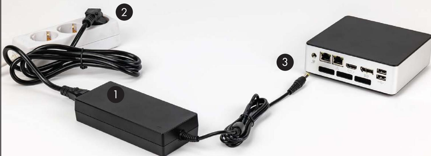
Подсоедините один конец кабеля питания к адаптеру переменного тока (1), а другой конец – к заземлённой электрической розетке (2), затем подсоедините адаптер переменного тока к разъёму питания неттопа (3).
